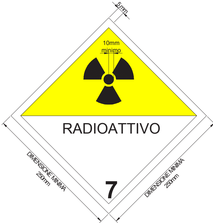
FIG.6 Placca. Ad eccezione di quanto permesso al paragrafo 571 le dimensioni minime devono essere come mostrato; quando si usano dimensioni diverse devono essere mantenute le relative proporzioni. Il numero "7" deve essere alto non meno di 25 mm. Il colore di fondo della metà superiore della placca deve essere giallo e della metà inferiore bianco, il colore del trifoglio e delle scritte deve essere nero. L'uso della parola "RADIOATTIVO" nella metà inferiore è facoltativo, al fine di consentire l'uso alternativo di questa placca per riportare il numero delle Nazioni Unite appropriato alla consegna.
